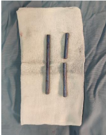
(Gambar 2. Rod sisi patah pada sisi kanan)
